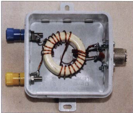
Bild 7: 200-W-Ausführung mit dem Kernmaterial 4C56
