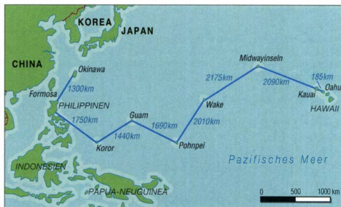
Bild 2: Bevor Satellitenkommunikation verfügbar war, nutzte das US-Militär Troposcatter für eine Gigahertz-Richtfunkstrecke zwischen Okinawa und Hawaii. Diese zeichnete sich trotz Einzelstrecken von maximal 2175 km durch eine hohe Verlässlichkeit aus. Karte: US Military, CC0, nachgezeichnet
