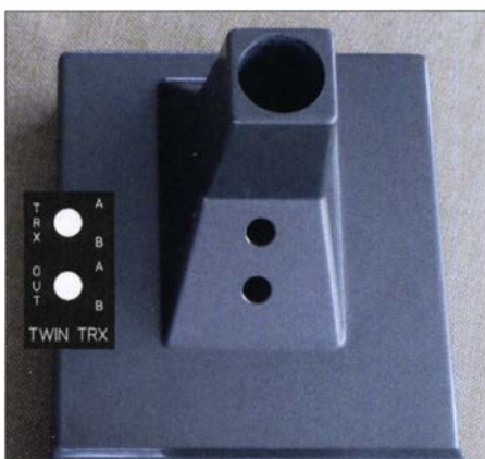
Bild 2: Mangels klarer Bezugskanten dient das Beschriftungsschild als Bohrschablone.
