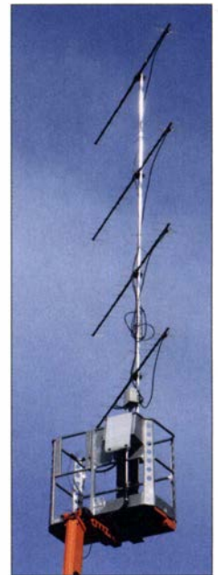
Bild 6: Die Contestgruppe DR9A verwendet auf 70 cm u. a. vier vertikal gestockte 15-Element-Yagis. Damit deckt sie einen vergleichsweise großen horizontalen Bereich mit hohem Gewinn ab, hat gleichzeitig einen flachen vertikalen Öffnungswinkel und aufgrund der Antennenhöhe einen für Troposcatter günstigen Strahlungswinkel.
