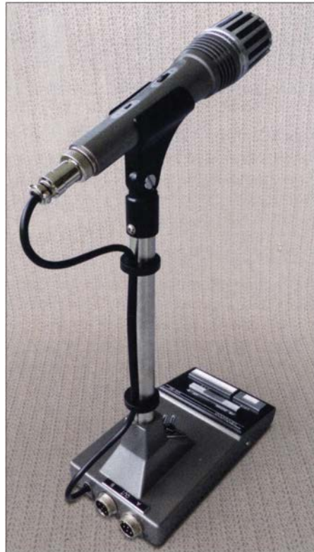
Bild 1: Modifiziertes MC-60A mit höher angebrachtem Mikrophon und Anschlussmöglichkeit für zwei Transceiver
