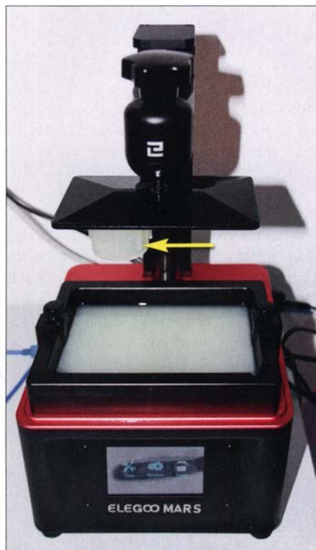
Bild 1: DLP-Drucker Elegoo Mars; in der Wanne befindet sich flüssiges weißes Harz und am Stempel hängt das gedruckte Werkstück.
