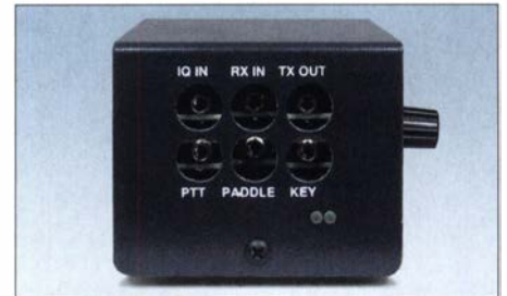
Bild 4: Auf der linken Gehäusesseite befinden sich Buchsen für NF-Signalleitungen, Morsetaste und Sende-Empfangs-Umschaltung.
