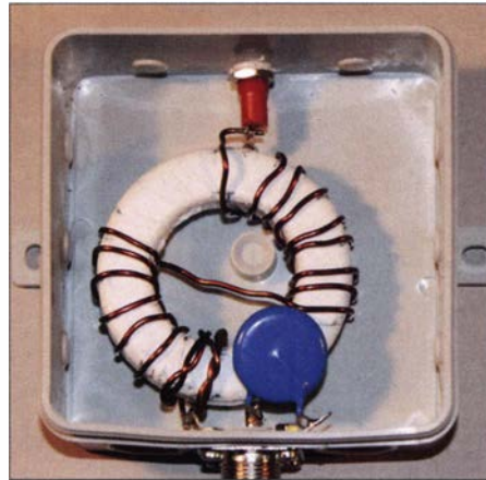
Bild 5: Mit PTFE-Band bewickelter FT240-43 für hohe Leistungen
