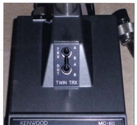
Bild 4: Mikrofonbasis nach erfolgter Modifikation Fotos: DJ0CA
